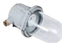
Fanale cilindrico tipo UNAV 2132 in ottone verniciato grigio marina con pressacavi UNAV 1948 230V IP66
