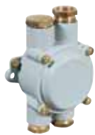
Cassette tipo UNAV 2161 in ottone verniciato grigio marina, con morsetti e pressacavi UNAV 1948 IP66
