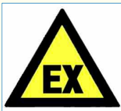
Figura 27: segnale che identifica le zone in cui si possono formare atmosfere esplosive
