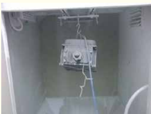
Figura 23: esempio prova IP POLVERE
