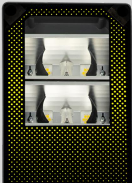
La gama FLIGHT con lentes de PMMA antienviejamiento, resistente a los rayos UV, con eficiencia >90% y transparencia >95%.
