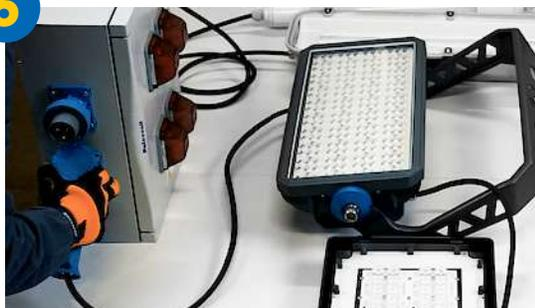
COLLEGA LA PRESA XCEE CHE ALIMENTA IL PROIETTORE IN ACCIAIO DARWIN ALLA SPINA XCEE SUL QUADRO TAIS CUBE CIECO
