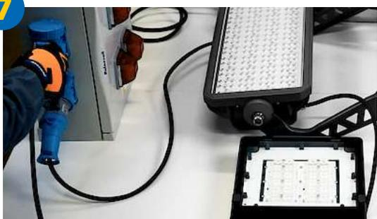
COLLEGA LA PRESA XCEE CHE ALIMENTA IL PROIETTORE IN ACCIAIO TIGUA ALLA SPINA XCEE SUL QUADRO TAIS CUBE CIECO
