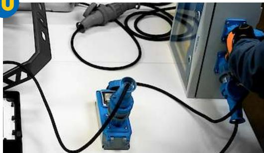
INSERISCI L'ADATTATORE TAIS NELLA PRESA ROTOR SUL QUADRO TAIS CUBE TRASPARENTE
