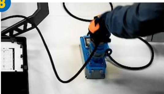
INSERISCI LA SPINA DEL PROIETTORE IN ALLUMINIO DARWIN ALLA PRESA INTERBLOCCATA ROTOR SULL'ADATTATORE TAIS
