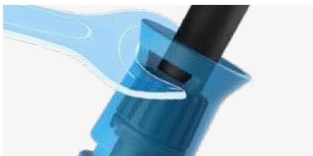
La semplicità si ritrova nel pressacavo smart che rende X-CEE adatta a tutti i tipi di cavi, con una versatilità unica sul mercato. È facilmente serrabile grazie alla possibilità di stringere il cavo facendo leva con un cacciavite. L'asola del pressacavo può essere usata anche come aggancio per la sospensione aerea.
