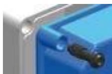
Vitoni di fissaggio in tecnopolimero rinforzato con fibra per una maggiore forza di serraggio con sistema antiperdita che trattiene il componente in sede e sicurezza antieffrazione grazie all'asola piombabile
