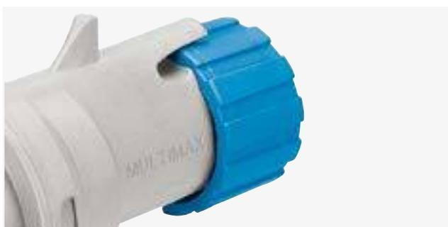
L'impugnatura delle spine Multimax integra un sistema di blocco automatico del pressacavo che protegge da possibili svitamenti accidentali. Il pressacavo può essere facilmente sbloccato sollevando il braccetto di tenuta.
