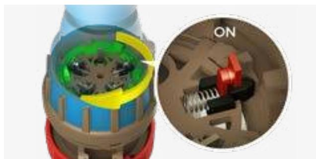
Per togliere la spina si ruota il safety ring in senso orario: l'interruttore disalimenta la presa e si estrae la spina in totale sicurezza.
