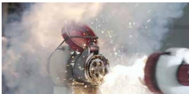
Il collegamento di un carico alla presa con un guasto a valle della spina, provocava una esplosione con rischio folgorazione dell'operatore.
