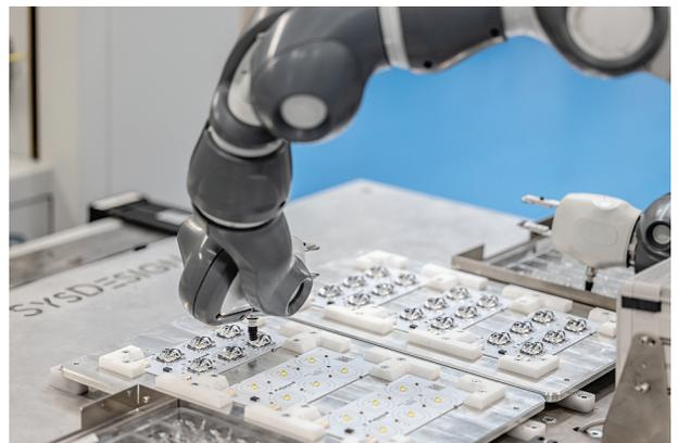
dotato di specifiche attrezzature. In questo settore l'azienda si sta dotando di robot collaborativi (detti COBOT), in grado di affiancare il personale replicando e memorizzando le manovre che sono state programmate pochi minuti prima. Si tratta di lavori ripetitivi, che vengono affidati a un robot sia per aumentare l'efficienza della filiera produttiva sia per poter dedicare preziose risorse umane ad attività elettive superiori.
