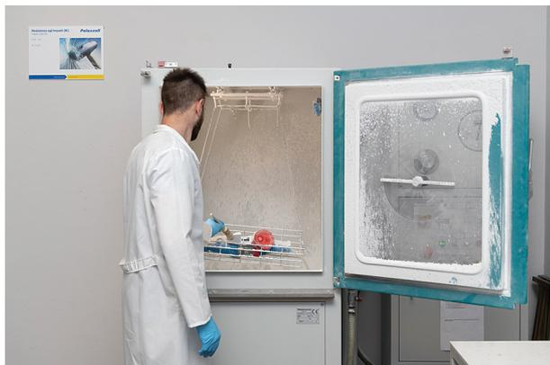
seguente possibile rischio d'incendio. Lo scopo del test è quello di verificare l'auto-estinguenza e la non propagazione di fiamma dei materiali isolanti.
